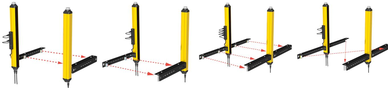
Fixez les supports pour capteurs d'inhibition SGS de Banner directement sur les rainures en T du boîtier des modèles SGS avec inhibition intégrée de Banner à l'aide des écrous en T et des fixations fournis. Raccordez les capteurs Q20 inclus à l'aide du boîtier de raccordement de l'inhibition ou de séparateurs adaptés.
